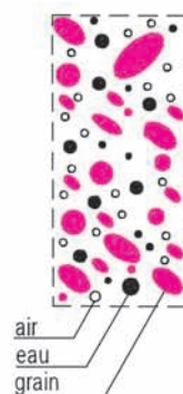
Fig. 27a : Structure du sol argileux
